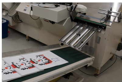
Плавно приемно устройство с електрически конвейер
