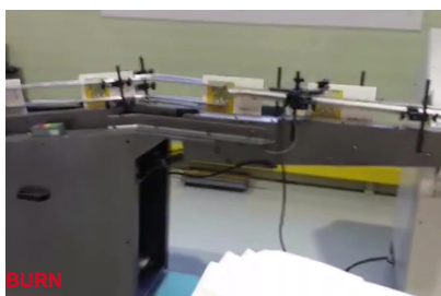
Свързване на отделните модули с плосък ремък
